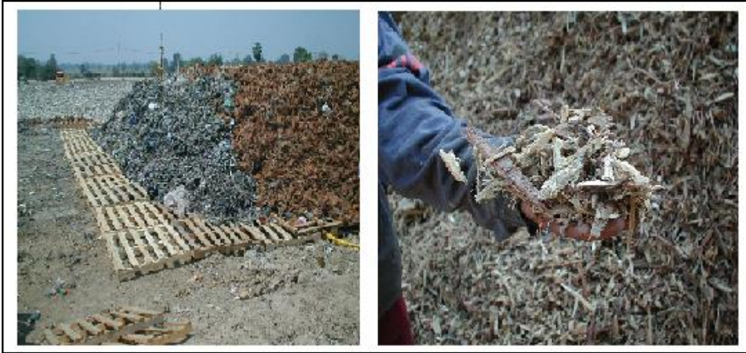
Şekil 3.5. MBA Tesisi Biyolojik Arıtma Ünitesinde Kullanılan Biofiltre Örneği ve Uygulaması
