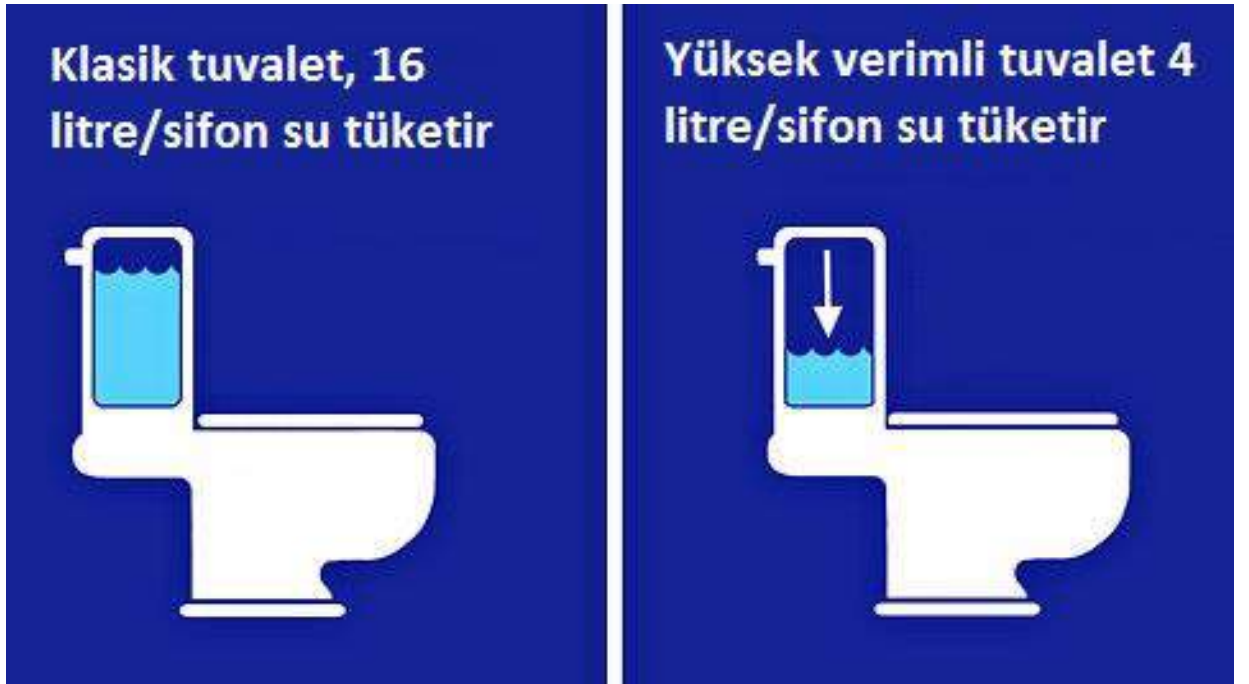
Şekil 2.1. Klasik Tuvalet Rezervuarı ile Yüksek Verimli Tuvalet Rezervuarı
