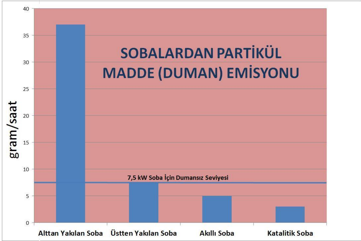
Şekil 3. Altan ve Üstten Yakmalı Sobalarda PM Emisyonu Farkı
