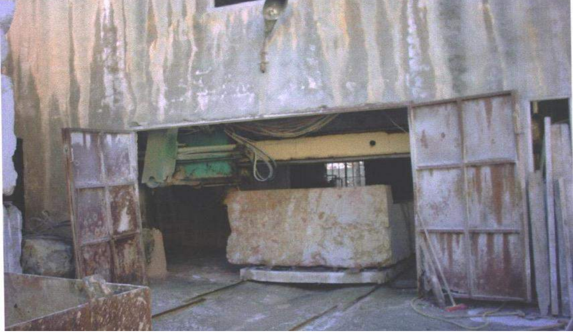
Resim 3. Mermer Kesiminde Kullanılan Kapalı Çerçevesi Katrak Kesim Görüntü.
